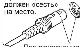
Для отключения, потяните штекер из разъёма, нажимая на выступ на штекере.
