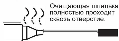
Очищающая шпилька полностью проходит сквозь отверстие.
